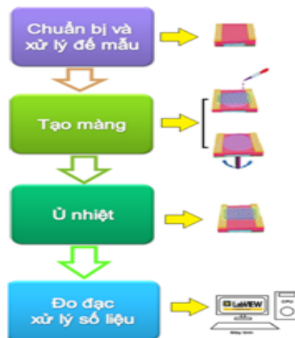
Hình 2.10. Quy trình chế tạo mẫu cảm biến từ vật liệu tổ hợp nano.
