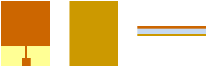
Hình 5.7. Cấu tạo của microwave anten (mặt trước; sau và mặt ngang)
